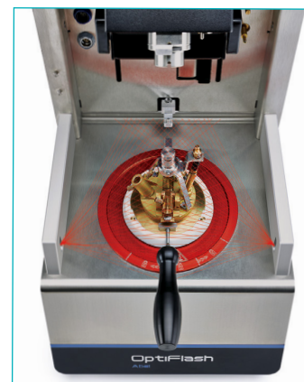
Optyczny system detekcji ognia monitoruje całą gorącą strefę
